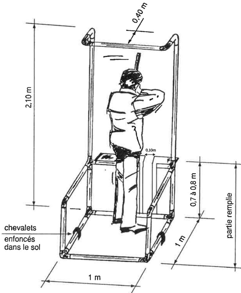
Poste de tir en tubes P.V.C. de couleur, diam. 50 mm
