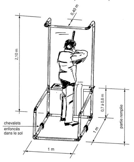
Poste de tir en tubes P.V.C. de couleur, diam. 50 mm Tubes droits + coudes emboîtables. Toute la partie basse étant remplie d'eau Ou de sable ou fixée au sol.
